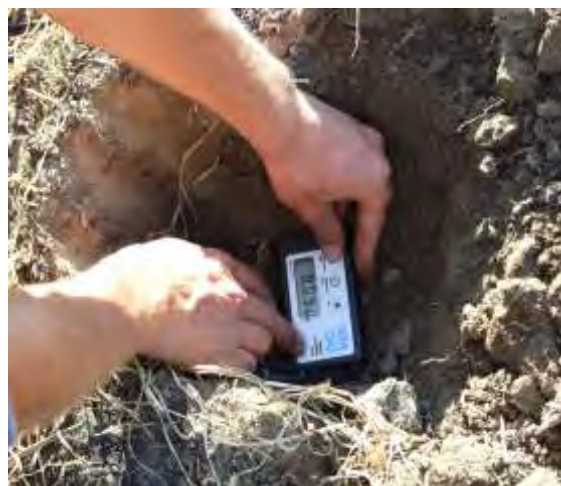
Fig. 2 – Măsurătorile de susceptibilitate magnetică au fost efectuate în aceleași puncte probate geochimic, prin omogenizarea solului pe toată adâncimea probată
