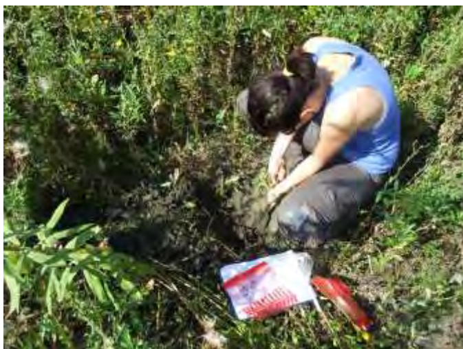
Fig. 1 – Prelevarea probelor geochimice: probele au fost prelevate din punctele localizate cu ajutorul GPS-ului, pe o adâncime de 25 cm, utilizându-se un deplantator metalic
