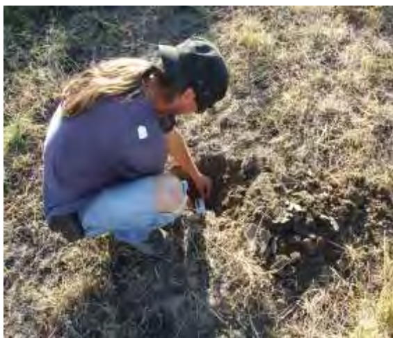
Fig. 2 – Măsurătorile de susceptibilitate magnetică au fost efectuate în aceleași puncte probate geochimic, prin omogenizarea solului pe toată adâncimea probată
