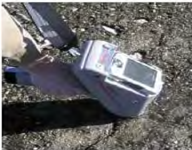
Figura 1. Instrumentul portabil X-MET utilizat pentru măsurarea conținutului de metale din sol
